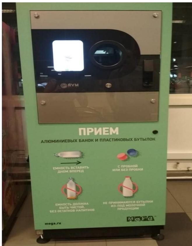
Рисунок 3.3-8 – Автомат по приему алюминиевых банок и пластиковых бутылок (ТЦ Мега) [3-31]
