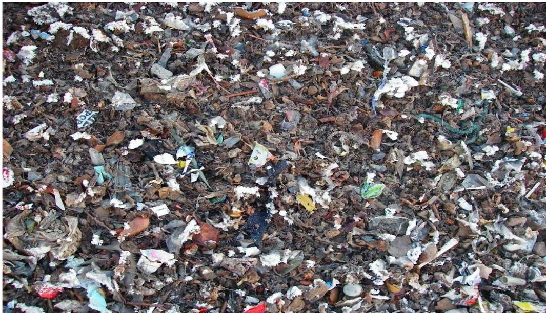
**Рисунок 4.4-8 – Внешний вид продукта, получаемого в рамках приведенного материального баланса (после грохочения продукта компостирования, фракция менее 25 мм)**
