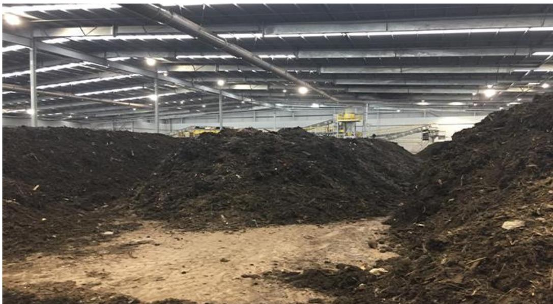
**Рисунок 4.1-14 – Участок закрытого буртового компостирования [4-14]**
