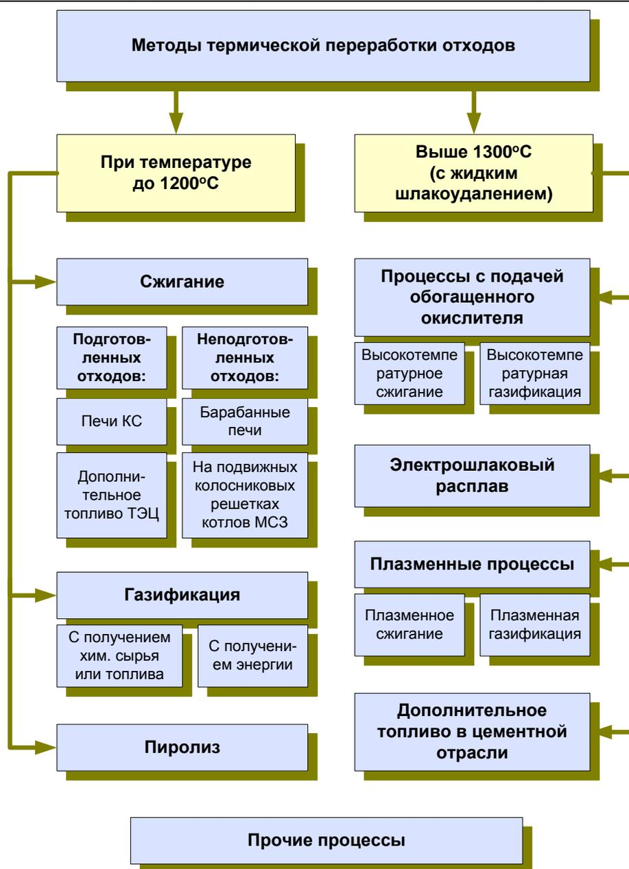
Рисунок 4.1-17 – Классификация термических методов переработки отходов
